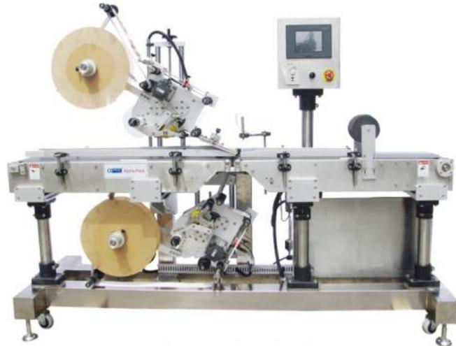
Labelautomat für vorgefertigte und bedruckte Etiketten
