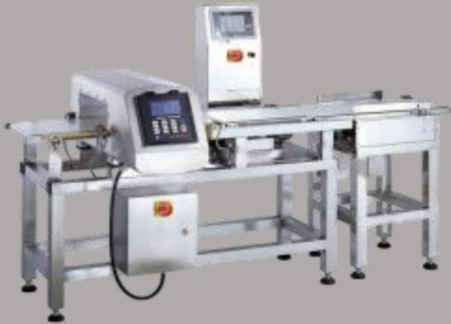
Metalldetektor inkl. Kontrollwaage
